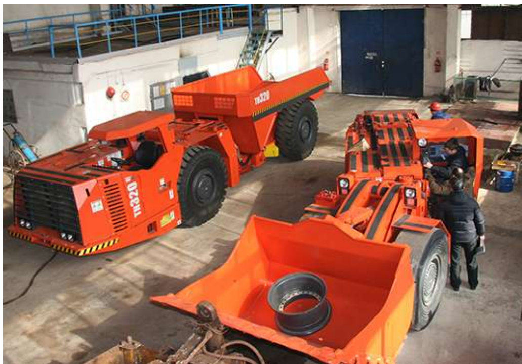
Рудовоз-самоскид TH 320, компанія-виробник «Sandvik», Фінляндія
