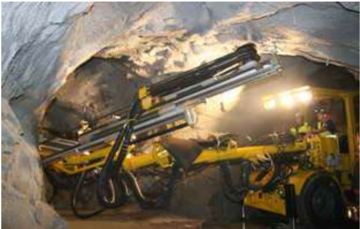
Бурова каретка «BOOMER-282», компанія-виробник «Atlas Copco», Швеція
